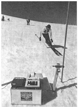
Arrivée à 3500 m d'altitude: cellule photoélectrique et imprimante de temps Centigraph HL 305.
