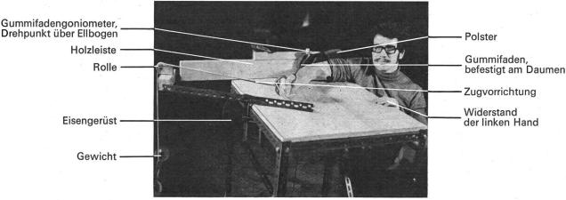
Fig. 1: Versuchsaufbau
