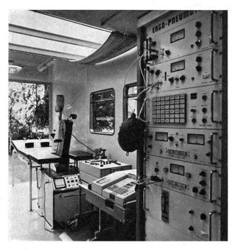
Auf der einen Längsseite des Wagenaufbaus ist ein vollständiger spiroergometrischer Arbeitsplatz mit Fahrradergometer, vollelektronischem Spirometriesystem mit direkter Datenverarbeitung durch Olivetti-Kleincomputer und 3-Kanal-EKG-Registriergerät installiert. Im wesentlichen handelt es sich dabei um die gleiche Anlage der Firma Erich Jaeger in Würz-
