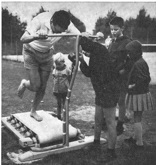
Le tapis roulant: le tachymètre indique la vitesse de course et la distance parcourue en une minute (test d'endurance).
