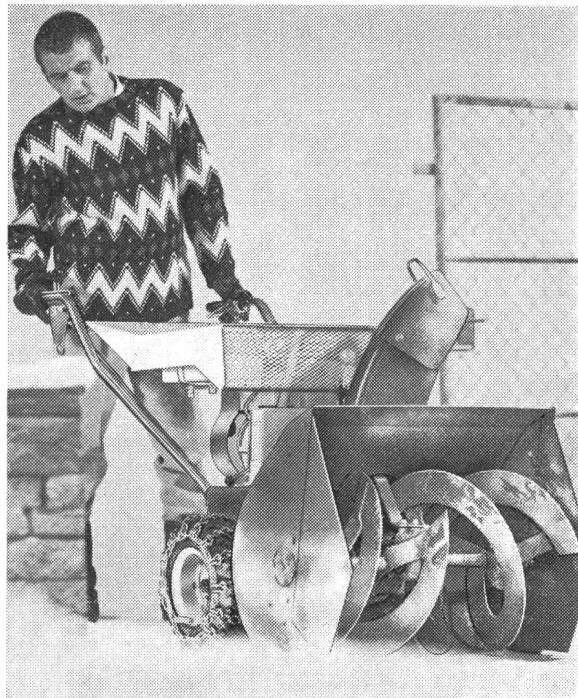
Le puissant moteur d'hiver Lauson 4 temps 6 CV permet d'utiliser la machine par n'importe quel temps et dans toutes les neiges. 4 vitesses avant et une arrière. Fraise à neige de 26" avec une largeur de travail de 65 cm. Double gradations. Canal d'éjection pivotant à 180°. Poids 135 kg.
