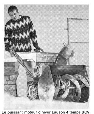
temps et dans toutes les neiges.4 vitesses avant et une arrière. Fraise à neige de 26" avec une largeur de travail de 65 cm.
