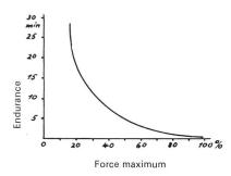
Durée de tension en fonction de la force de tension (selon Hettinger 3:38).
