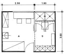
Fig. 3 A = Salle des maîtres, en même temps infirmerie, avec couchette, armoire pour matériel, pharmacie, porte-parapluies et penderie, table et chaises, lavabo, téléphone.
