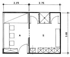
Fig. 2 A = Salle des maîtres, en même temps infirmerie, avec couchette, armoire pour matériel, pharmacie, porte-parapluies et penderie, table et chaises, téléphone.
