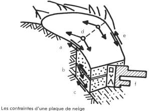
a et e = Ancrage-cisaillement. b = Rampement-cisaillement. c = Glissement, frottement-cisaillement. d = Traction. f = Faille de givre
