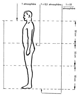
Schéma de la répartition des pressions sous l'eau à des profondeurs différentes. (D'après Krestownikow).
