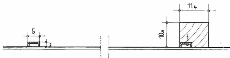
Le cercle de lancement est un engin pliable de 2 cm. de hauteur et de 5 cm. de largeur. Son diamètre est de 2,135 m. Dans le secteur du point de lancement, il est recommandé de fixer au cercle une poutre peinte en blanc.
