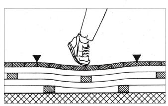
Flächenelastischer Holzboden mit Schwingbodenunterkonstruktion.
