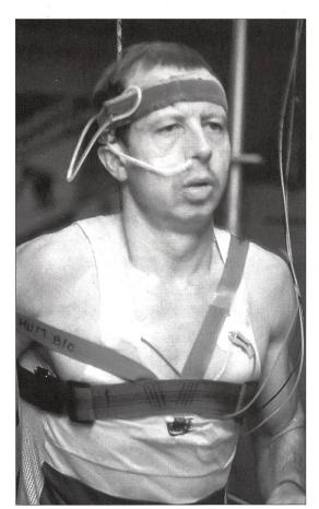
Langstreckenläufer auf dem Laufband, mit Magensonde zur Bestimmung der Magenentleerungsgeschwindigkeit.
