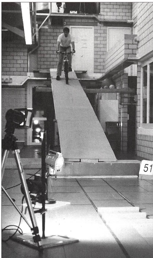
Versuchsrampe mit Locam-Kamera, mit welcher die Testfahrten aufgezeichnet wurden.
