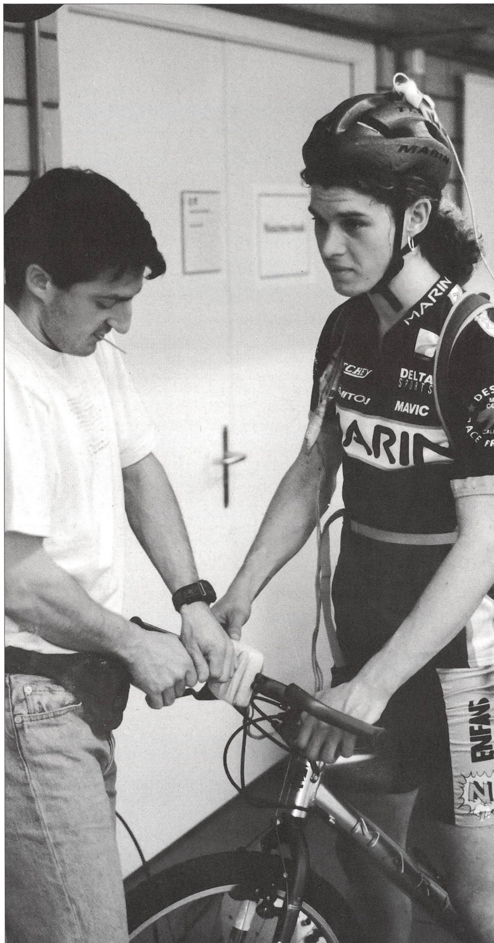
Befestigung des Beschleunigungsmessers am Lenker.
