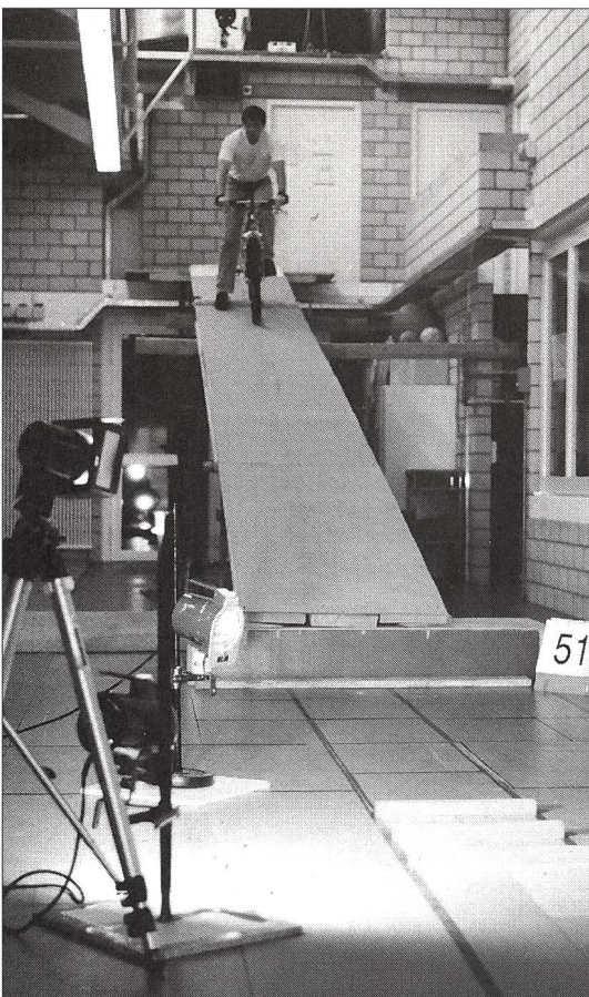
Versuchsrampe mit Locam-Kamera, mit welcher die Testfahrten aufgezeichnet wurden.
