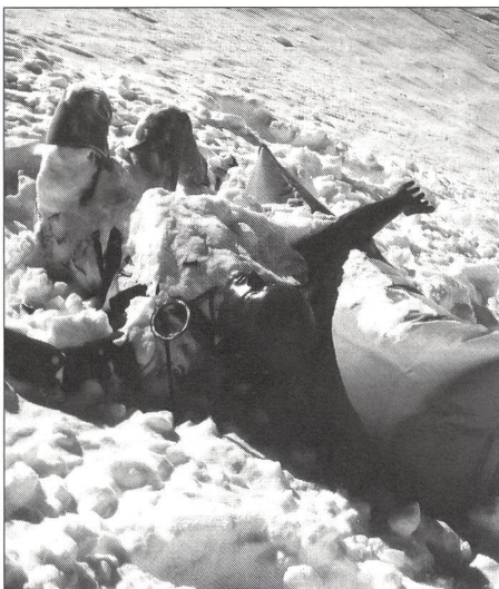
Versuchspuppe mit ABS-Lawinenballon nach dem Lawinnennieder-gang.
