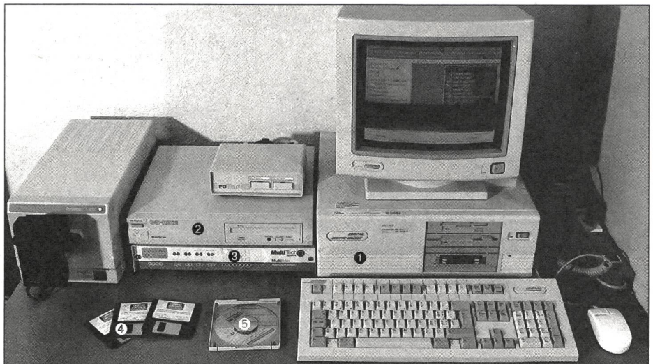
Das System am FI: Der schnelle Rechner ① (COMPAQ, Deskpro 486/25M mit 4MB RAM und 120 MB Harddisk), das CD-ROM Lesegerät ②, sowie den Multiplexer ③ für die Verbindung mit SWISSBASE. Das eingebaute Modem für die Abfrage auf DATA-STAR ist nicht sichtbar. Vor diesen Geräten liegend sehen wir folgende Datenträger: Disketten des CCOD ④ und die CD-ROM von Spolit ⑤.
