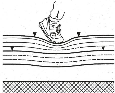
**\*Elastizität:** Die Elastizität eines Sportbodensystems hängt von der Konstruktion und von den verwendeten Materialien ab und zeigt an, wie sich der Boden unter Krafteinwirkung verformt. Die resultierende Verformung gibt den Grad der Elastizität an.
