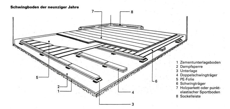
In den Jahren zwischen 1965 und 1975 wurde der Schwingboden durch punktelastische Produkte, hauptsächlich durch Polyurethanbeläge, verdrängt. In dieser Epoche hatte der Schwingboden zwei grundsätzliche Fehler:
