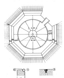
Aus Stahlbeton-Fertigteilen hergestellter Pool.
