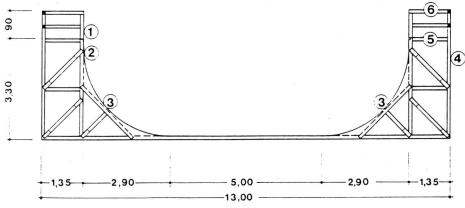
Schnitt durch eine Half-Pipe ① Rundrohr Ø 60 mm, ② Stützen und Verstrebungen aus Vierkantrohr, ③ Lauffläche aus 4 mm Hartaluminium, ④ Leiter, ⑤ Plattform, ⑥ Geländer.
