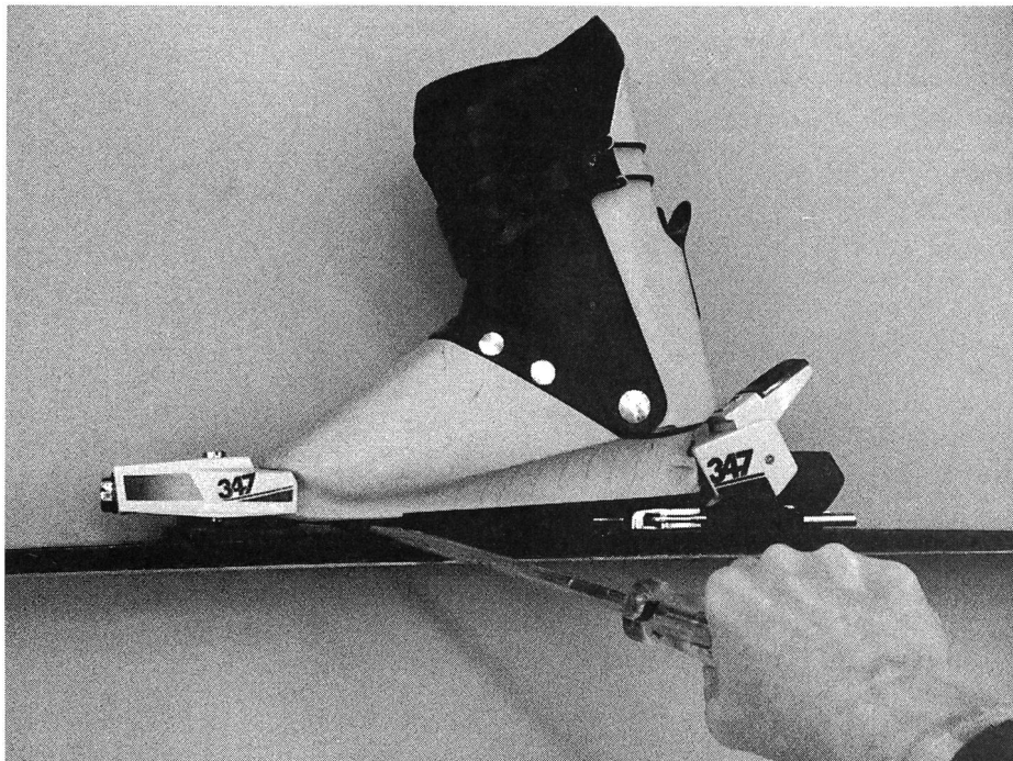
Kontrolle des Anschlagspiels zwischen Sohle und Gelenksegment des Bindung-Vorderteils.
