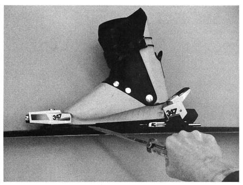
Kontrolle des Anschlagspiels zwischen Sohle und Gelenksegment des Bindung-Vorderteils.
