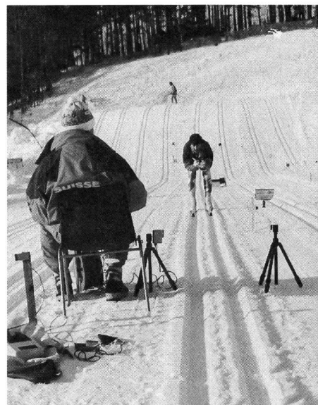
Gleittest: Testspur, Testfahrer, Lichtschranke und Testleiter, der das Testprotokoll führt.
