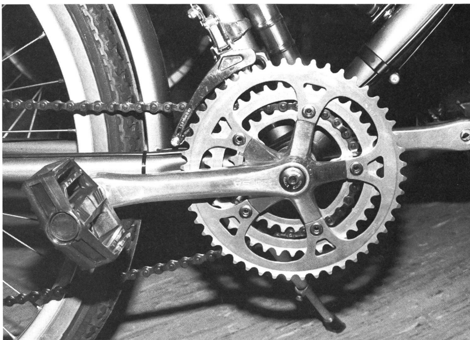
Das Tretlager eines MTB-Velos ist mit 3 Kettenblättern bestückt.
