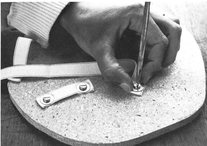
Nach dem Anbohren der Fixpunkte für die Befestigung der Schlaufen mit Ahle oder Bohrer werden die Elastikbänder verschraubt.
