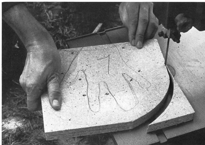
Ausschneiden der vorgezeichneten zwei Schläger mit Stich- oder Handsäge.
