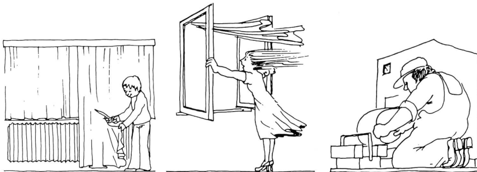
Heizkörper nicht verdecken, kurz und kräftig lüften statt dauerlüften, regelmässige Wartung der Heizanlage.
