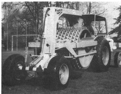
Aerifiziergerät mit motorisch angetriebenen Werkzeugen
