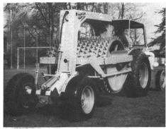
Aerifiziergerät mit motorisch angetriebenen Werkzeugen
