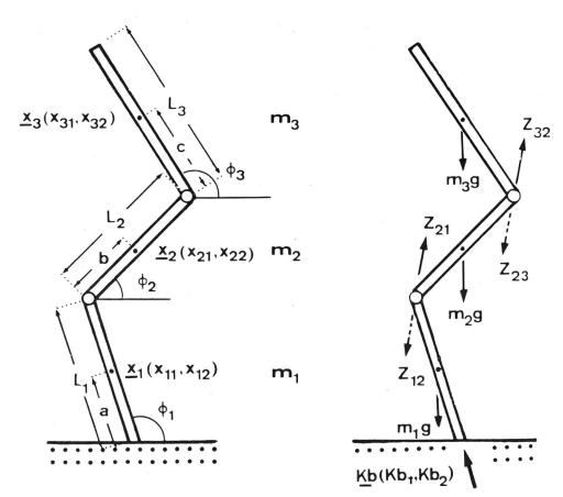
Abb. 3: Schematische Darstellung des dreigliedrigen Modells;a) Koordinaten und Geometrie, b) Kräfte
