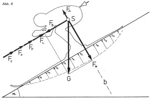
Abb. 6: Das Kräftesystem bei Geradeausfahrt.
