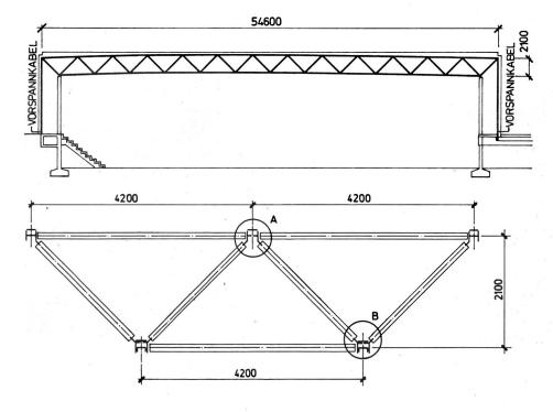
Tragsystem der Fachwerkträger. Querschnitt durch die Halle. Die Vorspannkabel ziehen die Fachwerk träger nach unten und entlasten damit das Fachwerk im Mittelbereich.
