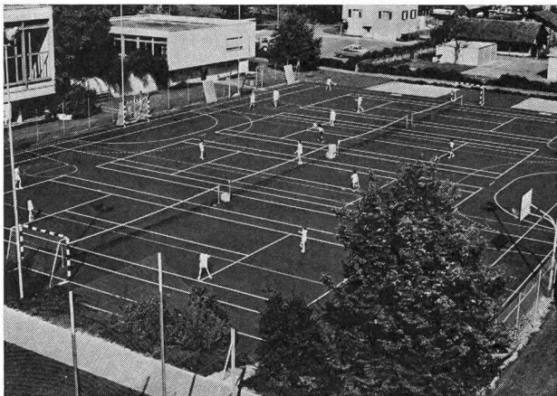
Turn- und Spielplatz in Meggen LU — Belagsmaterial: Duntoppor-Varioplast, offenporig polyurethan-versiegelt, rot.
