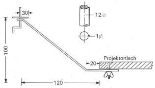
Bild 13 Befestigung der Filmspulenhalter am Projektionstisch.
