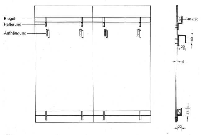
Bild 4a Rück- und Seitenansicht der Koordinatenwand. Die angegebenen Masse (in mm) erlauben, die Wand an die gebräuchlichen Reckanlagen, Barren und Sprossenwände anzuhängen.
