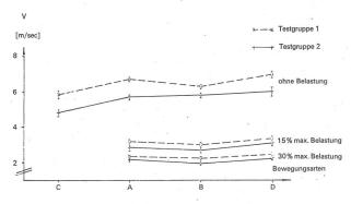
Fig. 6: Einfluss der Bewegungsarten auf die Tangentialgeschwindigkeit
