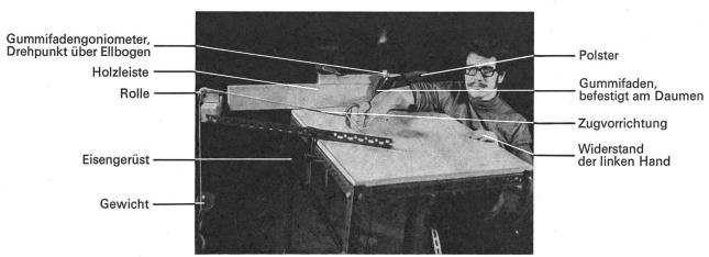
Fig. 1: Versuchsaufbau
