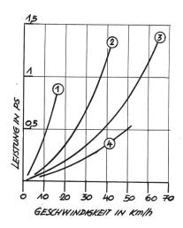
Abb. 1 Effektive PS-Werte in Funktion der Geschwindigkeit in km/h, umgerechnet nach den spezifischen Leistungsangaben PS/t von Kármàn.
