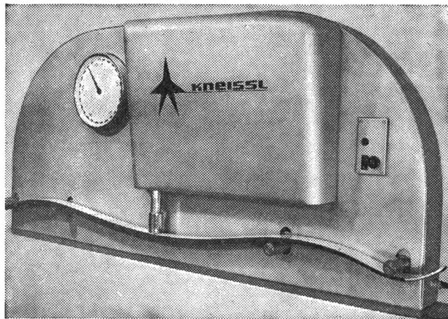
Testmaschine für die Prüfung der unerreichten Dauerhaftigkeit (Druck 500 kg!) und Elastizität der KNESSL-Kunststoffskis — elastisch durch die geteilte Kante.
