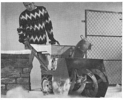
Der starke 6-PS-4-Takt-Lauson-Winter-Motor gewährleistet den Einsatz in jedem Schnee und jeder Witterung. 4 Vorwärtsgänge und 1 Rückwärtsgang. 26" Schneefräse mit 2 Arbeitsstufen. Arbeitsbreite 65 cm. Auswurfrohr um 180° drehbar. Gewicht 135 kg.
