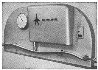
Testmaschine für die Prüfung der unerreichten Dauerhaftigkeit (Druck 500 kg!) und Elastizität der KNEISSL-Kunststoffskis – elastisch durch die geteilte Kante.
