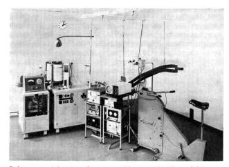
Spiroergometrie. Anordnung zur Messung der Dauerleistungsfähigkeit. Bestimmung der maximalen Sauerstoffaufnahme, der Pulsfrequenz und mehrerer anderer Werte. Metabograph und Ergometer nach Prof. Fleisch
