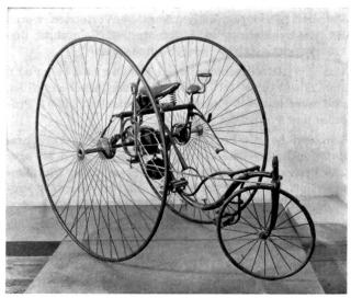
Tricycle «Front Steerer» engl. Fabrikat ca. 1884. Omnicycle mit zwei oszilierenden Trommeln, Kettenantrieb und Übersetzungen sowie Schirmständer. Länge 180 cm, Höhe 130 cm, Breite 105 cm.
