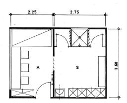
Abb. 2 A = Aufenthaltsraum, zugleich Sanitätsraum, mit Liegebett, Materialkasten, Sanitätskasten, Schirmständer und Kleiderhaken, Tisch mit Stühlen, Telephon.
