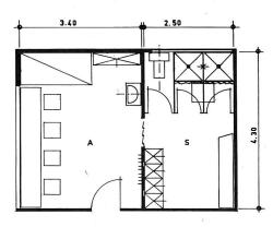
Abb. 4 A = Aufenthaltsraum, zugleich Sanitätsraum, mit Liegebett, Materialkasten, Sanitätskasten, Schirmständer und Kleiderhaken, Tisch mit Stühlen, Lavabo, Telephon.
