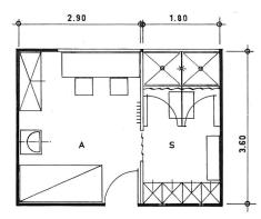
Abb. 3 A = Aufenthaltsraum, zugleich Sanitätsraum, mit Liegebett, Materialkasten, Sanitätskasten, Schirmständer und Kleiderhaken, Tisch mit Stühlen, Lavabo, Telephon.
