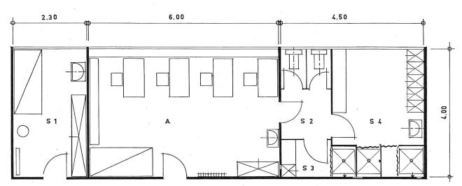
Abb. 5 A = Aufenthaltsraum mit Materialkasten, Lavabo, Lehrerpulten mit Stühlen, evtl. Liegepritsche, Telephon, Schirmständer mit Kleiderhaken. S1 = Sanitätszimmer mit Liegebett, Lavabo, Sanitätskasten, Messgeräte etc. S2 = 2 WC, Geruchschleuse. S3 = Turnlehrerinnenumkleide mit Dusche, 2 Turnkleiderkästchen, Sitzbank und Desinfiziersprühe. S4 = Turnlehrerumkleide mit 10 Turnkleiderkästchen, Sitzbank, Lavabo, 2 Duschen und Desinfiziersprühe. Fläche: ca. 52,00 m².
