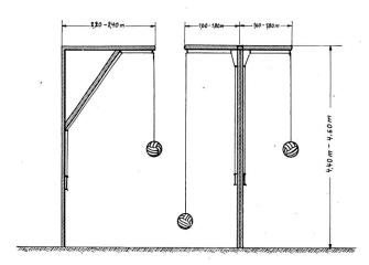
wird aus Sparsamkeit eine solche Vorrichtung am Tribünendach oder an einer Mauer befestigt. Auf Grund einer schlechten Seilführung und des geringen Lichteinfalls ist eine solche Anbringung nicht ratsam. Bei der Führung des Seiles sollen keine Rollen verwendet werden, da das Seil sehr schnell aus der Rolle springt und sich verklemmt. Die Befestigung des Balles soll mittels einer am Ball angenähten Lederschlaufe erfolgen. Karabinerhaken und Metallringe führen zu Verletzungen.
