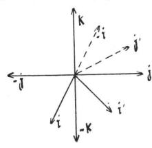
symétrie normal. En effet si i et j sont 2 vecteurs-unités perpendiculaires dans le plan normal à l'axe binaire et k le vecteur-unité coïncidant avec cet axe, le dyadic 3, équivalent à l'axe binaire, multiplié par l'inversion donne le dyadic 4, qui est le plan de symétrie normal (fig. 19).
