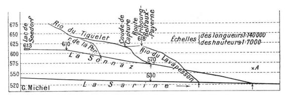
Fig. 26. Profil des lits de la Sonnaz, avec son affluent le rio du Tiguelet, et du rio du Lavapesson. Remarquer la brusque rupture de pente dans le lit du Tiguelet en aval du coude de capture.
