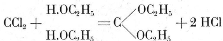
Par saponification de cet éther, on a de l'oxyde de carbone et de l'alcool
