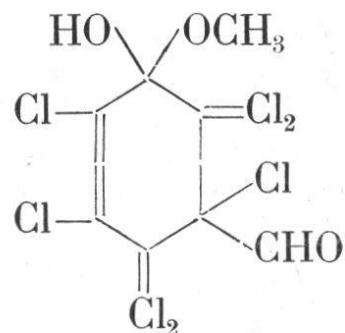
Si l'on prolonge la réaction, 3 atomes de chlore sont remplacés par 3 groupes —OCH<sub>3</sub>, et, en même temps, le groupe aldéhydique réagit avec un atome de chlore pour donner de l'oxyde de carbone et de l'acide chlorhydrique :
