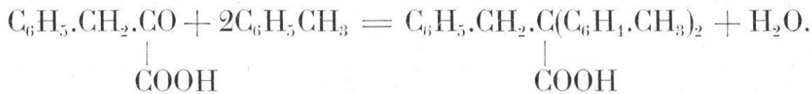
Die Kondensation wurde mittels kalter konzentrierter Schwefelsäure ausgeführt mit Toluol, o-Xylool und Äthylbenzol, während sie mit Benzol, m- und p-Xylool nicht zum Ziele führte.
