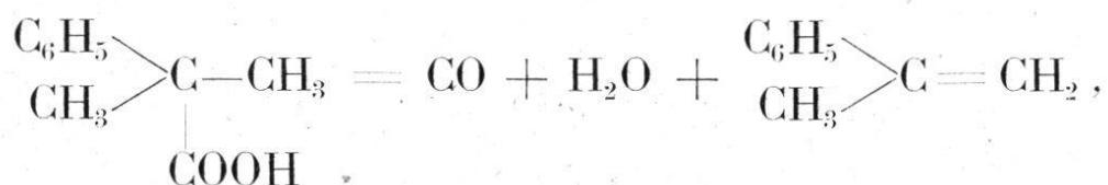
oder vielmehr vermutlich ein Polymeres desselben, da das Styrol durch konzentrierte Schwefelsäure polymerisiert wird<sup>2)</sup>. Ein solcher Kohlenwasserstoff hätte sich aber beim Eingießen der schwefelsauren Lösung in Wasser unlöslich abscheiden müssen. Es war also die Bildung anderer Reaktionsprodukte behufs ihrer Isolierung in Betracht zu ziehen.
