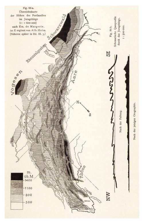
Fig. 04: Carte orographique de l'altitude des couches du Portlandien dans la chaîne du Jura (Extrait de Heim, 1921, p. 551). Sur le côté droit, deux profils NW-SE à travers la chaîne. Celui du haut représente l'altitude après le plissement et celui du bas l'altitude actuelle. On peut donc estimer l'érosion selon Heim.
