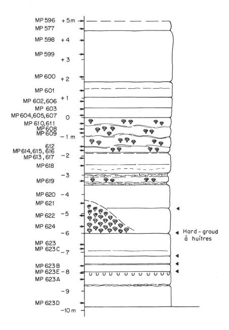
Fig. 13. — «Coupe de la Brunette», succession de faciès urgoniens à Serrières, en face des Fabriques de Tabac Réunies S.A. Position des échantillons indiquée à gauche; triangles noirs à droite: hard-grounds.
