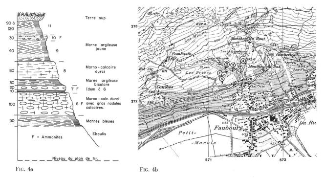
FIG. 4a. — Succession du stand de tir au pistolet, à 50 m, selon le lever de R. BUSNARDO, août 1984, après rafraîchissement du talus. Epaisseur en centimètres.
