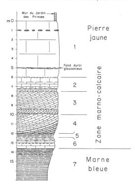
FIG. 9. — Succession lithologique dans la paroi du portail N du tunnel de Prébarreau. Les bancs purement calcaires des niveaux 1 à 4 et 6 correspondent à des grainstones de composition variable. Pour cette raison, les détails lithologiques n'ont pas été figurés.
