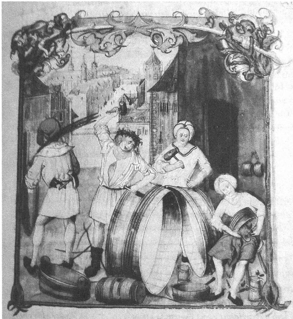
Abb. 6 Krakauer Böttcherwerkstatt unter freiem Himmel mit Blick in eine lange Gasse. Die Gesellen treiben die aus halbierten Weidenruten bestehenden Reifen, die ein anderer heranträgt, auf die Bottiche. Der Lehrling putzt einen kleinen Melkkübel aus. Illustration aus: Bruno Bucher, Die alten Zunft- und Verkehrsordnungen der Stadt Krakau nach Balthasar Behem's Codex Picturatus in der k. k. Jagellonischen Bibliothek, Wien 1889, Tafel XXV.
