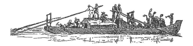
Abb. 7: Wiener Zille («Ulmer Schachtel»). Das 22 bis 30 m lange und 3 bis 7.5 m breite Flachbodenschiff hatte ein Freibord von 1.5 m. Es besass zum Schutz der Passagiere und wertvoller Güter eine mittige Holzhütte. Bei der einmaligen Fahrt flussabwärts wurde das Fahrzeug mittels je 1 bis 2 Heck- und Bugstangen oder -ruder gesteuert. Am letzten Zielort wurden die Boote zum Nutzholzpreis verkauft, weil deren Rückführung zu aufwändig gewesen wäre. 144
