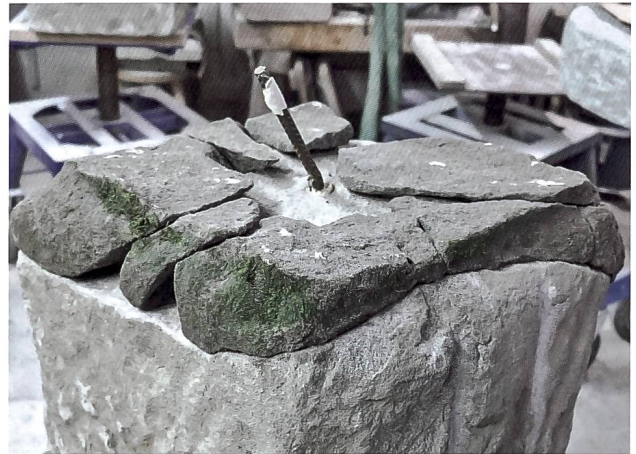
Die Abrissstelle mit aufgelegtem Puzzle und rostigem Armierungseisen (Foto: Daniel Ledergerber).
