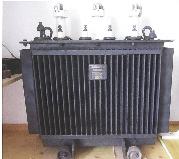
Der Drehstrom-Öltransformer der Firma Brown, Boveri & Cie., fotografiert im Elektromuseum Reichenburg von Armin Mettler.
