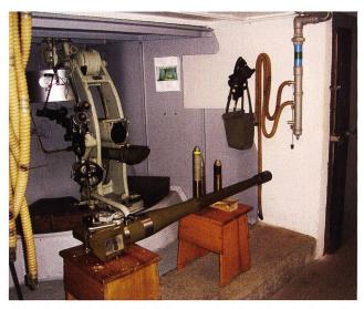
Abb. 39 Die Bk 37 im Werk Grynau. Das Geschützrohr ist auf der Abbildung eingezogen, im Hintergrund ist die Ständerlafette mit dem Schiesspanorama zu erkennen.
