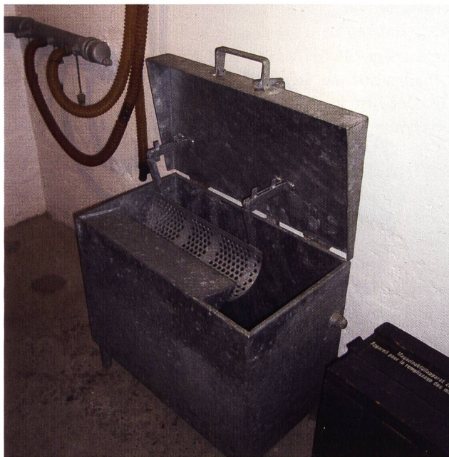
Abb. 57 Kasten zur Kühlung der heissen MG-Läufe
