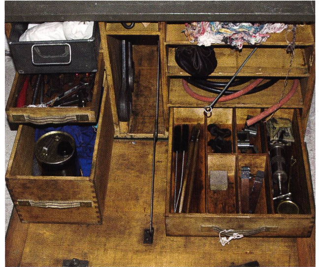
Abb. 65 In jedem Mg-Stand war eine Mechanikerkiste eingelagert, die mit ihren Werkzeugen und Ersatzteilen Reparaturen an der Waffe ermöglichte.
