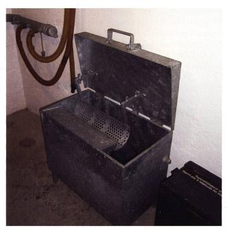
Abb. 57 Kasten zur Kühlung der heissen MG-Läufe
