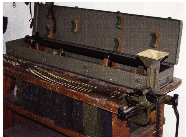
Abb. 63 Der Munitionstisch fasste 18 Gurtkisten à 250 Schuss. Zudem war daran ein Gurtabfüllapparat befestigt.
