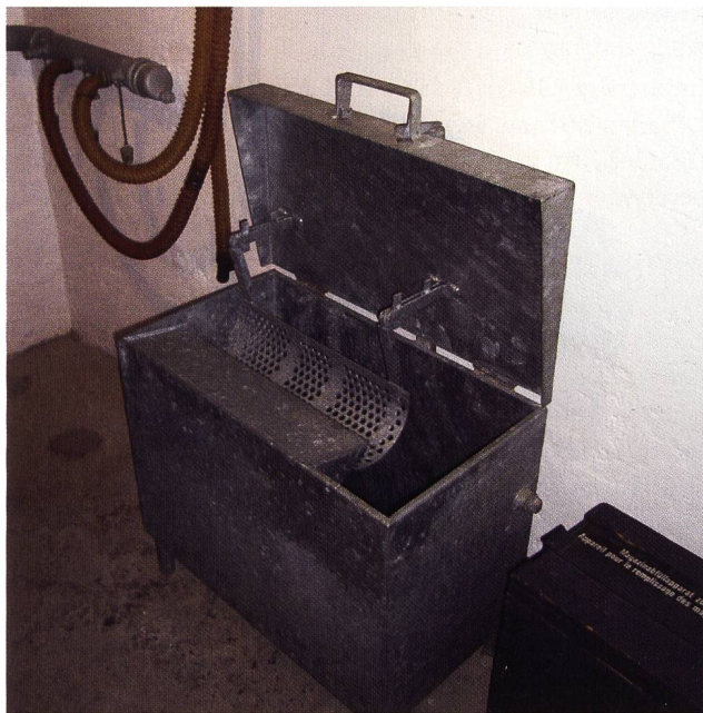
Abb. 57 Kasten zur Kühlung der heissen MG-Läufe
