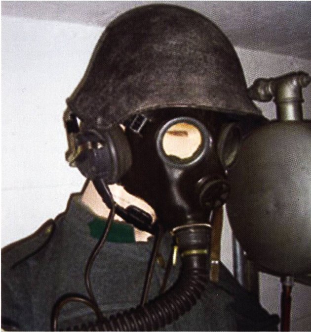
Abb. 35 Lärmsprechgarnitur. Am Hals ist das Kehlkopfmikrofon gut zu erkennen.
