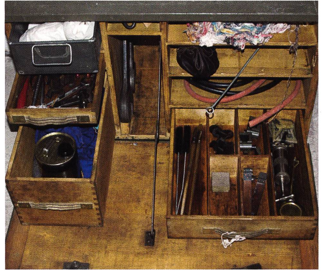
Abb. 65 In jedem Mg-Stand war eine Mechanikerkiste eingelagert, die mit ihren Werkzeugen und Ersatzteilen Reparaturen an der Waffe ermöglichte.
